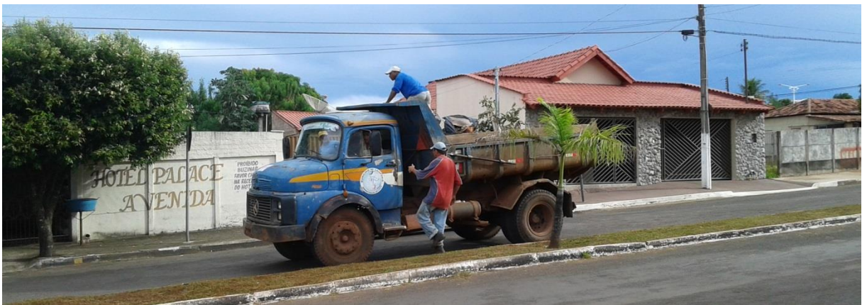
Figura 103. Veículo utilizado na coleta de resíduos e garis sem EPI's. Fonte: TERRA Consultoria, Estudos e Projetos Ambientais, 2015.
