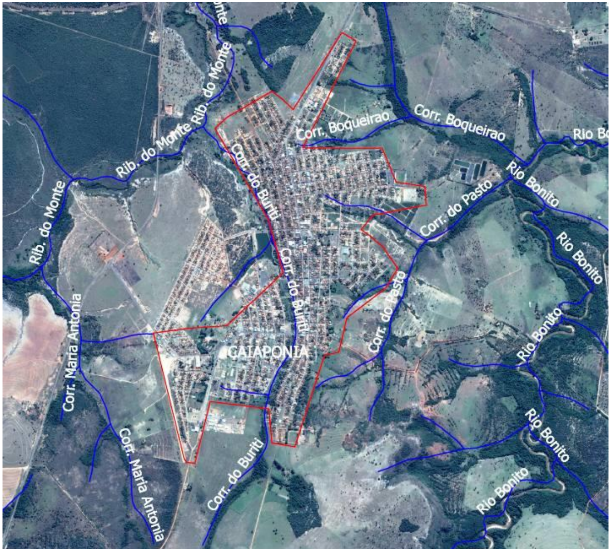
Figura 69. Fundos de vale e potenciais corpos receptores no entorno da zona urbana. Fonte: Google Earth, TERRA Consultoria, Estudos e Projetos Ambientais, 2015.
